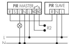
Vergrößerung des Bereiches mit einem bzw. mehreren Slave-Geräten. Achtung: Der Master muss immer an der dunkelsten Stelle montiert werden.
